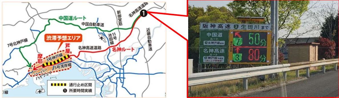
経路比較情報板①(名神高速道路(西行) 吹田 JCT 手前)設置状況と、比較ルート
