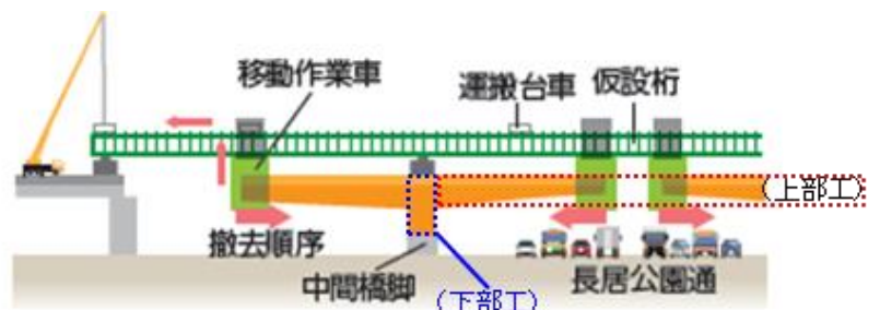
既設コンクリート橋梁の撤去(上部工・下部工)
