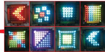
従来から、事故の多いカーブに設置していたマルチカラーポイント滅灯を、トンネル内カーブにも設置します。点滅の模様や色のパターンを変えることにより、効果的に注意喚起を行います。
