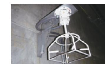
超音波を利用して、風向きや風速を測定しています。
