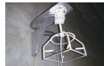
超音波を利用して、風向きや風速を測定しています。
