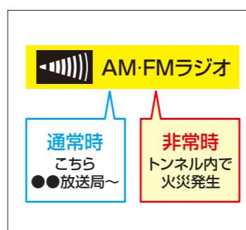
通常時はトンネル内で、AM・FMラジオの再放送を流しています。もしトンネル内で緊急事態が発生した場合、通常流れているラジオ放送の電波に割り込ませて、トンネル内に緊急放送を行います。
