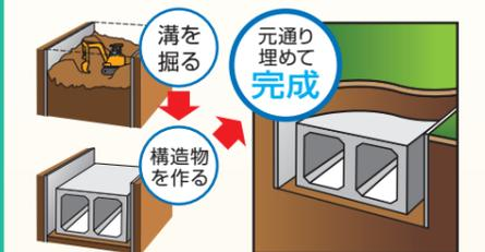
溝を掘るように、地面を削った所にトンネルを作り、構造物が完成したら元の高さまで埋め戻します。
