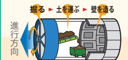
大きなドリルのようなシールドマシンを使って地中を掘り進むと同時に、トンネルの内壁を作ります。
