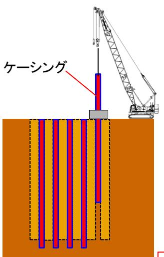
鋼管矢板の継手部を先行削孔し、
