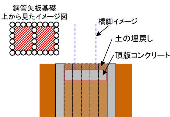
PPE-4 (頂版コンクリート打設完了)
