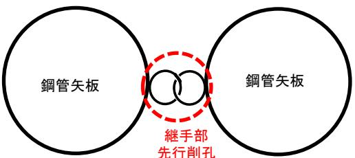
PPE-6 (継手部先行削孔完了)
