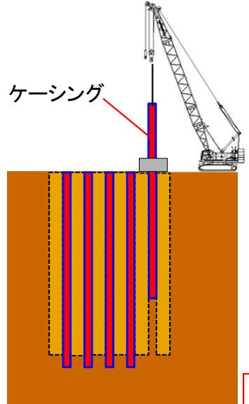
鋼管矢板の継手部を先行削孔し、
