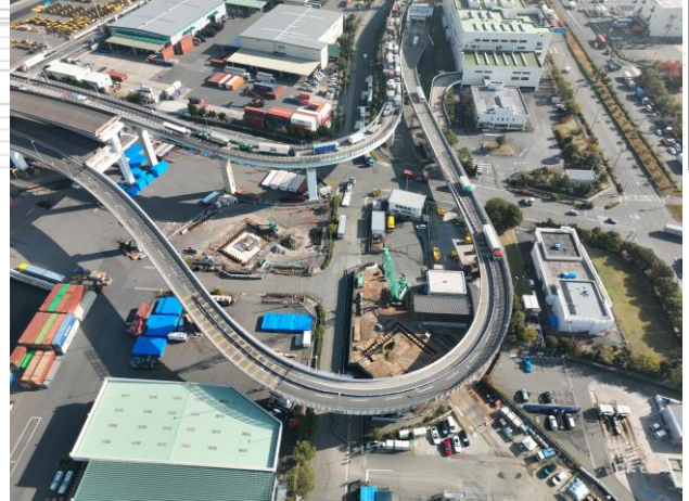
写真③ PPE-1 埋戻し完了 PPE-2 鋼管矢板打込完了
