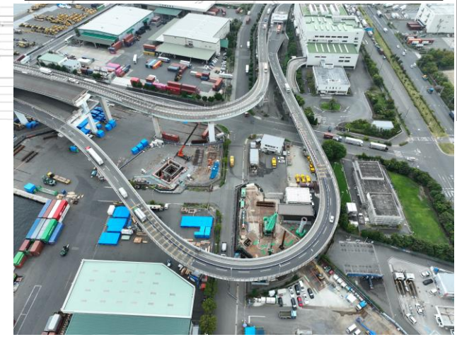
写真③ PPE-1 頂版鉄筋組立完了 PPE-2 鋼管矢板打込中
