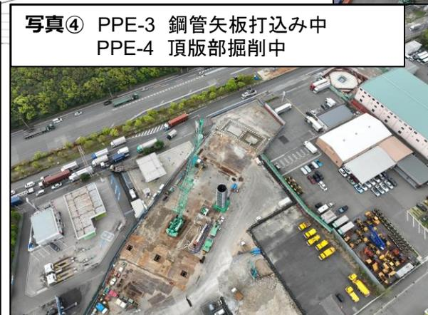
写真④ PPE-3 鋼管矢板打込み中
