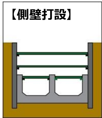
(6) 切梁を外し、 側壁を打設する。
