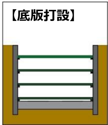
【底版打設】 (5) 本体工の底版 を打設する。
