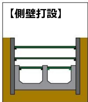
(6) 切梁を外し、 側壁を打設する。
