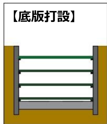
(5) 本体工の底版 を打設する。
