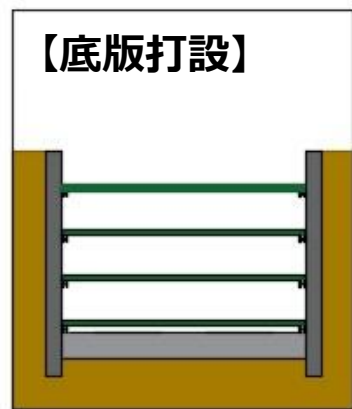
(5) 本体工の底版 を打設する。
