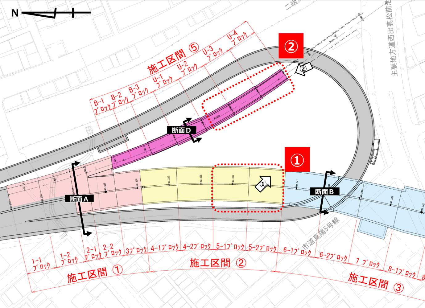
① 頂版打設に支障となる切梁・腹起しの撤去ができたため、頂版部の型枠、鉄筋組立を実施中。
