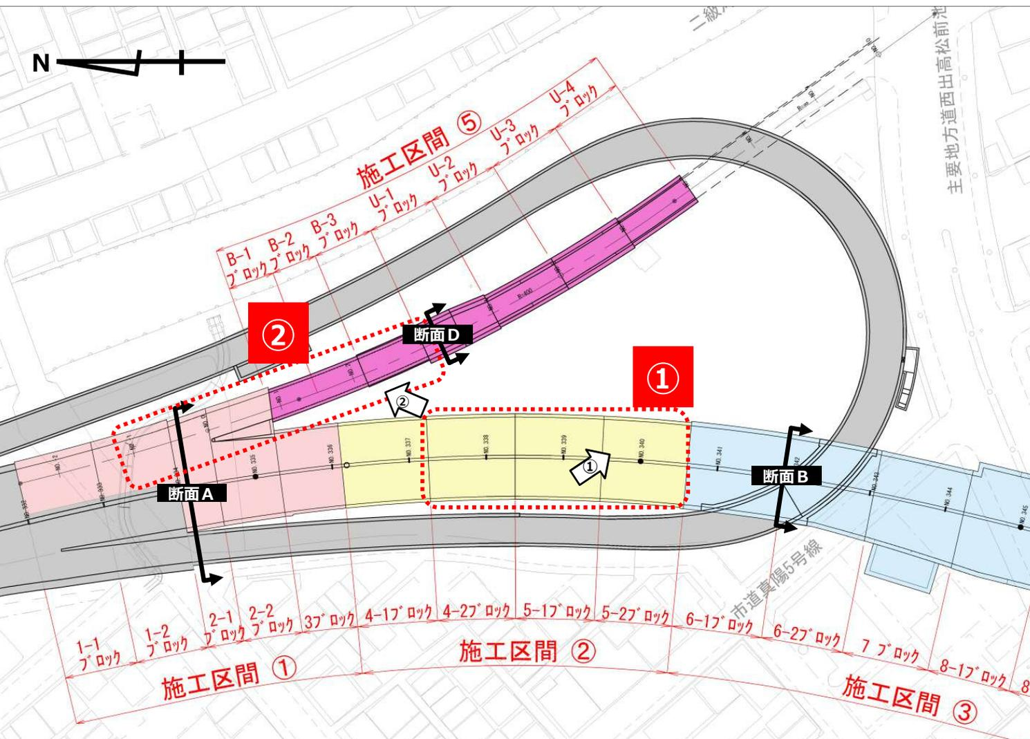
① 開削トンネルの函体工事に向け、側壁コンクリート打設に向けた足場組立を実施中です。
