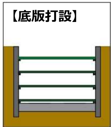
【底版打設】 (5) 本体工の底版 を打設する。
