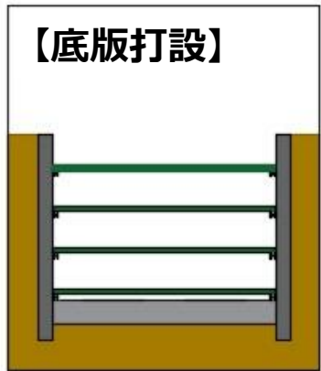
(5) 本体工の底版 を打設する。
