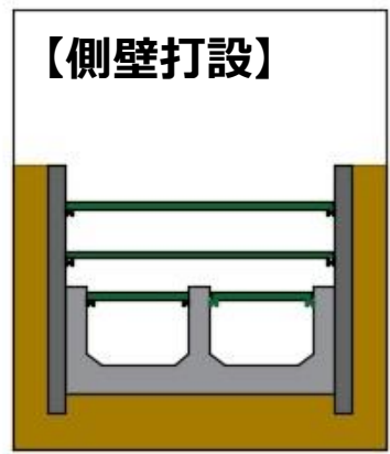
(6) 切梁を外し、 側壁を打設する。
