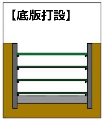
(5) 本体工の底版 を打設する。
