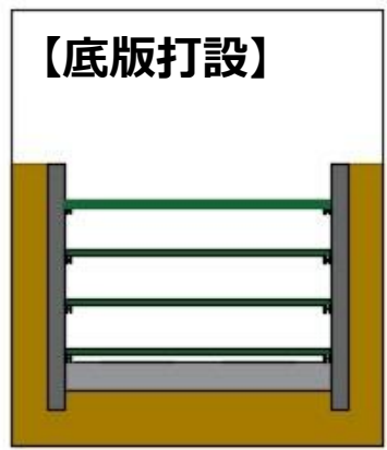
(5) 本体工の底版を打設する。
