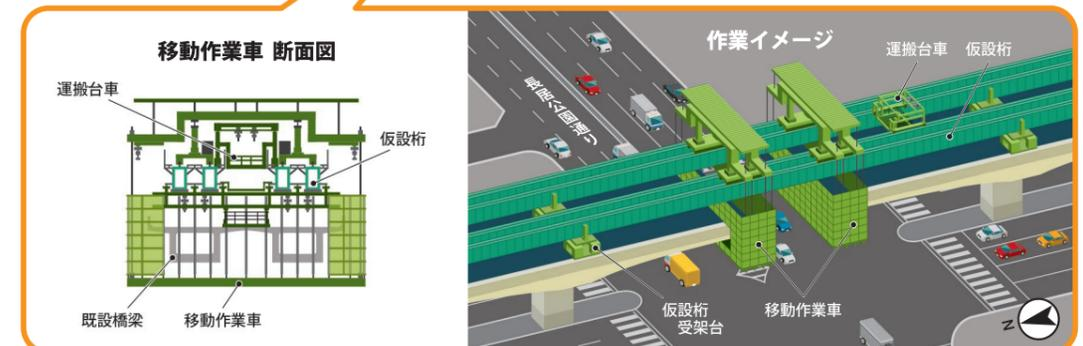
橋梁の架替えを行うことで、沈下が進行している「ヒンジ部の垂れ下がり」を解消し、永続性（長期の維持管理性）を確保するとともに、最新基準を満足させることにより長期耐久性の改善を図ります。
