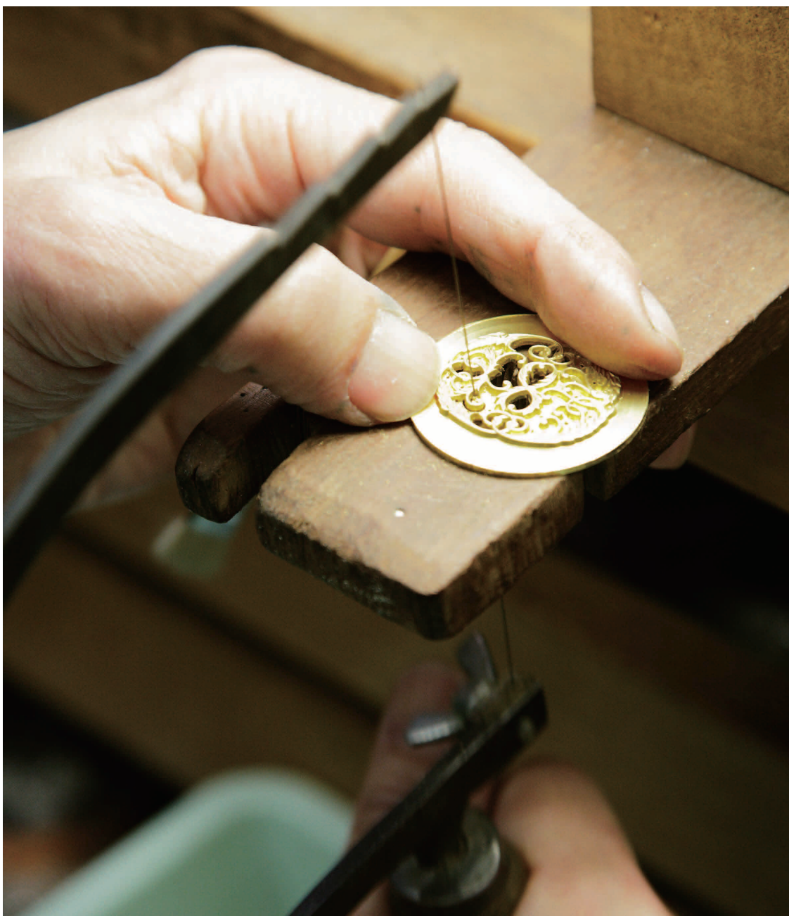
ゴリゴリゴリ……。装飾を浮かび上がらせていく糸のこの音だけが、上田さんの手元で小さく響いている。大勲位菊花章頸飾の首飾り部は、「明治」の「明」と「治」の古篆字と唐草がデザインされた3種類、計24個のパーツからなり、ひとつひとつ手作業でロウ付けしていく。大勲位菊花章頸飾は、海外の国王などからいただいた勲章に対する、儀礼叙勲としても授与される。
