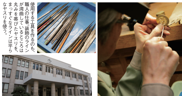
糸のこで模様を切り取った後、切り取った箇所すべてにヤスリをかける。形を崩さないようヤスリをかけるのではない。糸の子で切りきれなかった、細かな装飾の模様をより美しく“形作る”のが、ヤスリがけという仕事だ。
