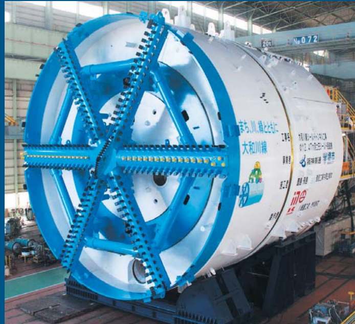
阪神高速道路(株)施工区間(本線)シールドマシン Shield machine for the section of Hanshin Expressway Company Limited (main route)
