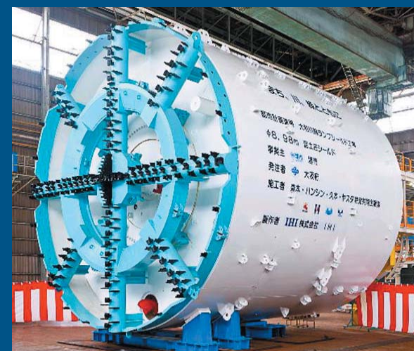
大阪府施工区間(ランプ部)シールドマシン Shield machine for the ramp section of the Osaka Prefecture section
