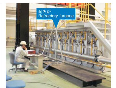
実物大模型を用いた耐火性能試験の状況 Fire resistance test using life-size model
