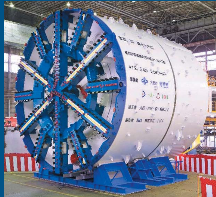
大阪府施工区間(本線)シールドマシン Shield machine for the Osaka Prefecture section (main route)
