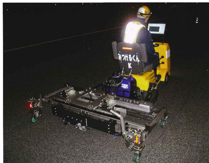
▲ 鋼床版検査装置 (検出装置部)
