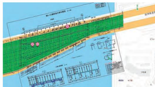
舗装損傷と鋼床版き裂発生位置の重ね合わせ表示例
