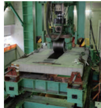
接合部安全性確認のための実物大試験状況
