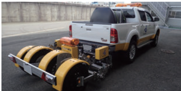
すべり抵抗調査車両 (RT3 ® Curve)
