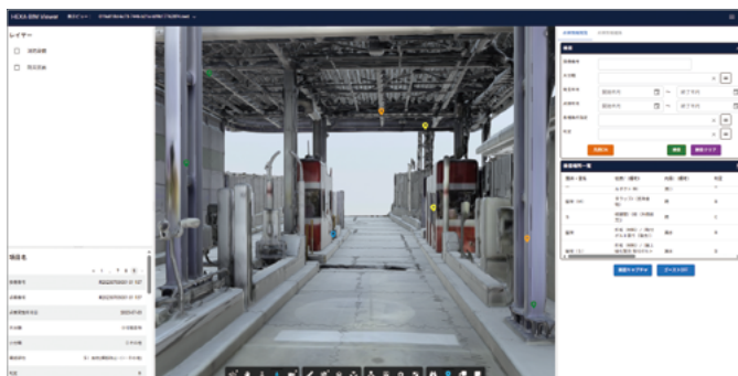
料金所点群モデル(モデル内のアイコンは点検ピンを示す)
