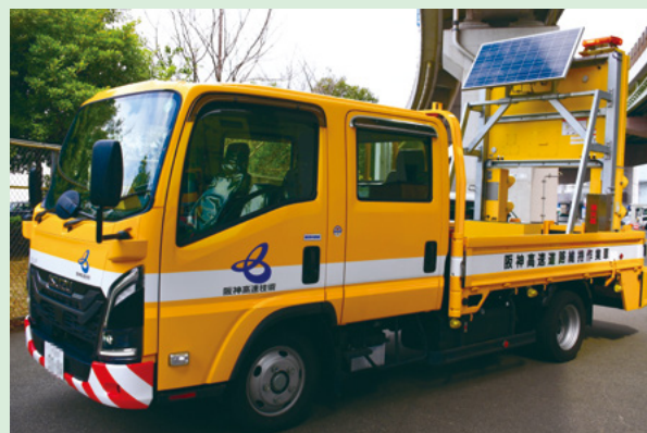
標識車のソーラーパネル
