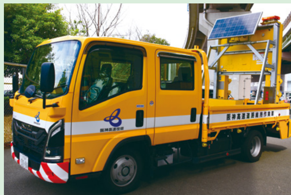
標識車のソーラーパネル
