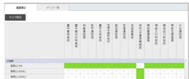
図-13 路側 L2 スイッチの状態監視画面
