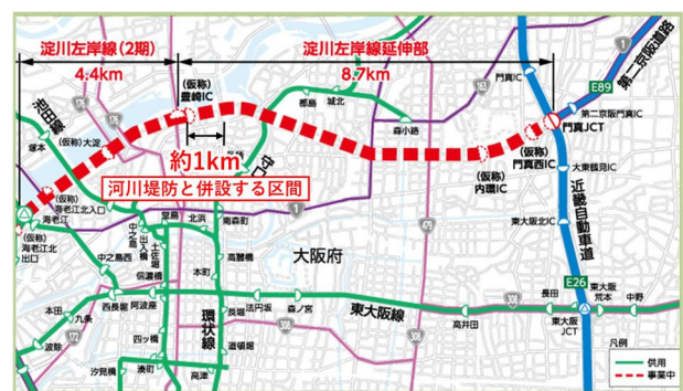
図-1.1 淀川左岸線延伸部の路線全体図
