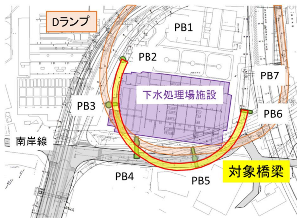
図-9 多軸台車を用いた一括架設対象橋梁
