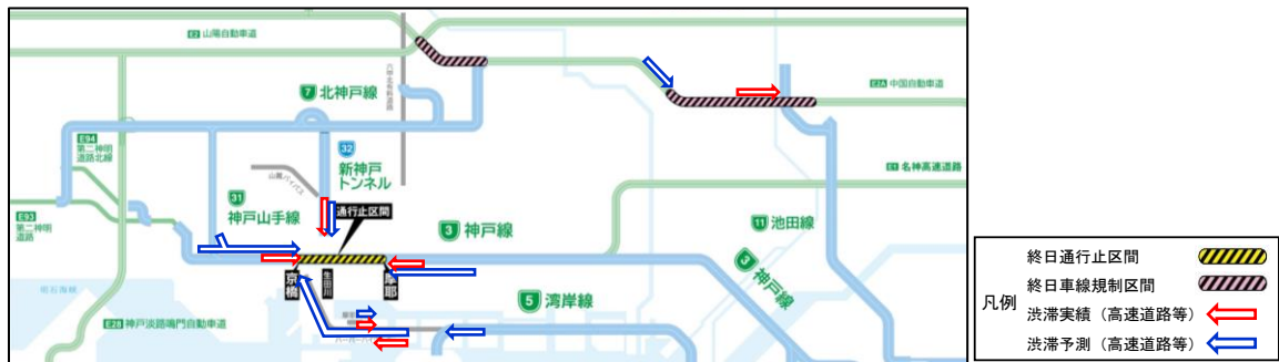
図-12 通行止め実施日の高速道路等の17時台の渋滞長(予測と実績の比較)
