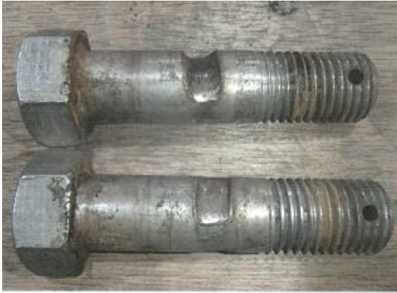
写真-1 ジェットファン吊り金具用 ピンボルトの異常摩耗
