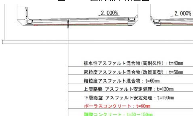
図-5 D区間標準断面図
