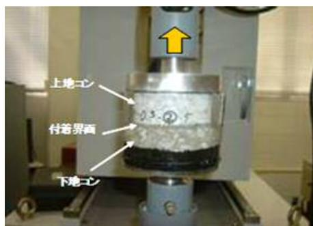
写真-3 水浸引張疲労試験の実施状況
