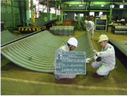
写真-1 ソケット鋼管工場検査
