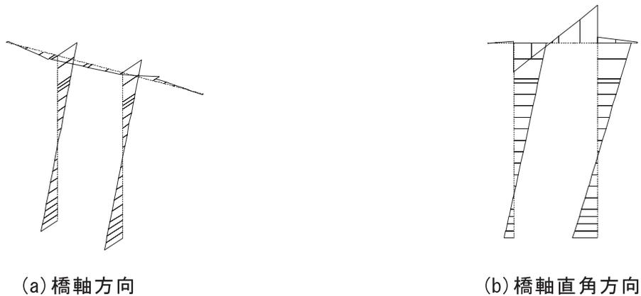
図-2 地震時曲げモーメント図
