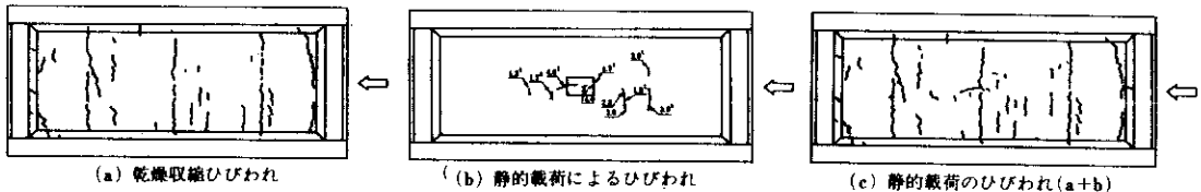
図-3 静的載荷時のひびわれ状況 (供試体No.5)
