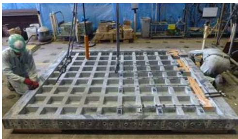
超高強度繊維補強コンクリート(UFC)を用いた床版
