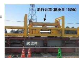
載荷試験の様子
