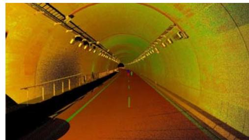
3Dレーザースキャンによるトンネル内計測
