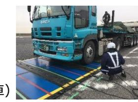
\* 軸重計測を実施し、道路構造物や舗装に悪影響を及ぼす軸重違反車両を取り締まることで、損傷の発生を抑制
