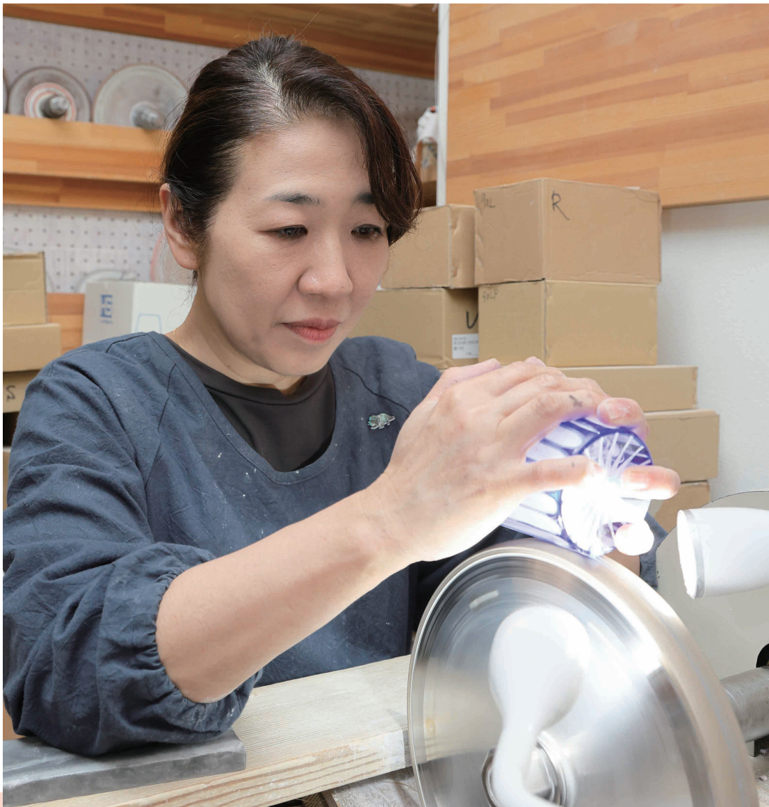
天満切子の最大の特徴は、ガラスの側面をU字型に削っていくこと。薩摩切子や江戸切子で使われるV字型のシャープな刃ではなく、U字型の刃を使ってガラスの側面にU字の凹みをつけるように大胆に削っていく。写真の工程は、「粗削り」。「技術を身につけるといのは、自分の感覚でできるようになること。そのためには、数を削って自分のものにしていくしかないですね(西川さん)」。
