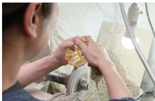
磨き粉となる泥をつけながらコルクで磨くと、半透明だったガラスが、つるつるピカピカの透明のガラスに生まれ変わっていく。
