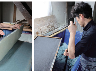
漉いて水を切った和紙は翌日、板に貼り付け天日で干す。雁皮は急激に乾燥させると板からはがれやすいため、蒸気を使った効率のいい機械乾燥ができない。今も一枚一枚、日光に当てて自然に乾燥させる。
