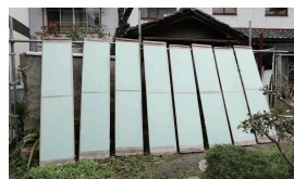
漉いて水を切った和紙は翌日、板に貼り付け天日で干す。雁皮は急激に乾燥させると板からはがれやすいため、蒸気を使った効率のいい機械乾燥ができない。今も一枚一枚、日光に当てて自然に乾燥させる。
