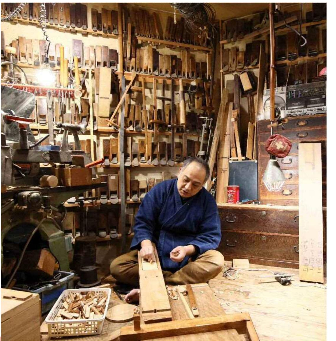
「正直台」(裏返した鉢がはめられた台)で側板の側面を正確に削っていく。このあと、側面の角度が正確にすべて揃った側板を円形に組み、外側を「外丸鉢」で、内側は「内丸鉢」で割り上げる。さらに、底板をはめ、たがで縫い込み、完成。製作過程では側板と側板の合わせ目に、糊も使うが、糊は水に濡れることが前提だから、糊で水濡れを防ぐという考えはない、合わせ目の角度を正確に合わせて、たがの縫い込みで側板を密着させて水を止めています。(近藤さん)
