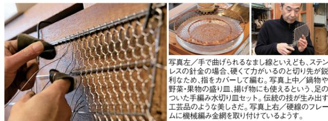
写真左/手で曲げられるなまし線といえども、ステンレスの針金の場合、硬くて力があるのと切り先が鋭利なため、指をカバーして編む。写真上中/鍋物や野菜・果物の盛り皿、揚げ物にも使えるという、足のついた手編み水切り皿セット。伝統の技が生み出す工芸品のような美しさだ。写真上右/硬線のフレームに機械編み金網を取り付けているようす。
