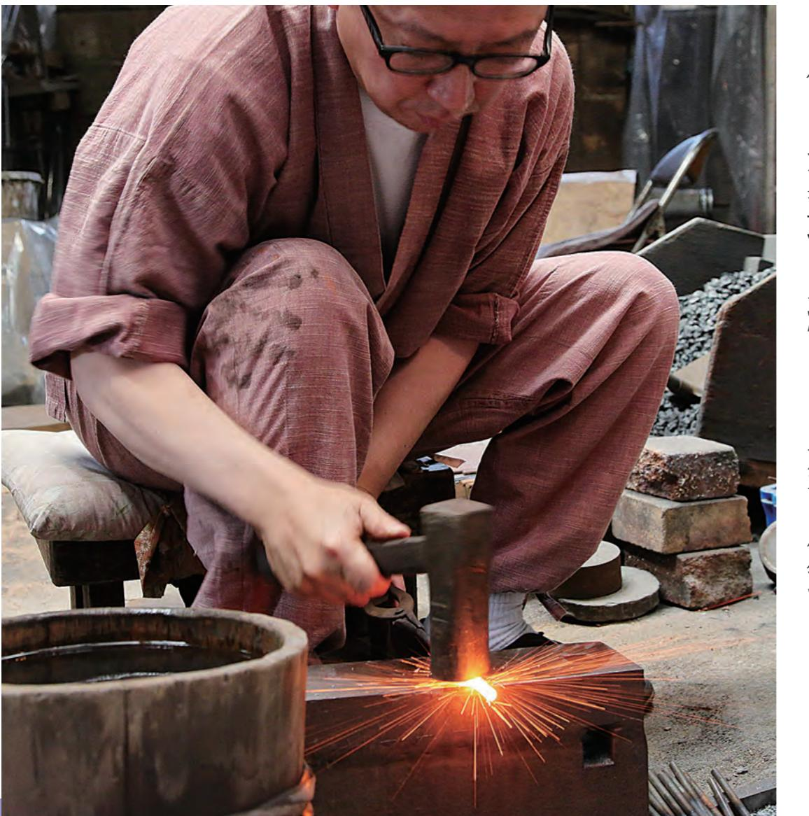
トントン、トントン、トントン…。美しい音色、響きを存分に引き出すように、気を抜くことなく、無心に、丁寧に鉄を打つ。しかも、焼けた鉄が冷めるまでの一瞬のうちに。打つ火箸の材質や、長さ、太さによっても打つ時の力加減、回数を変えながら、1日に1万回以上、鎧を振る。
