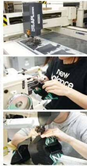
工房では、ウォータージェットで素材を裁断。縫製は、昔ながらの足踏みミシンを使って、ひとつずつ人の手で縫われ、靴ができあがっていく。
