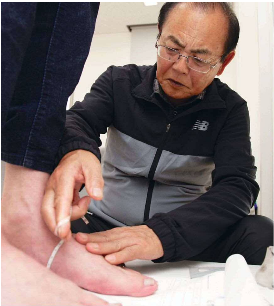
素足の足型を写し、メジャーや三角定規で足の甲の高さなど17カ所を測定する。17カ所の測定箇所の詳細については、「企業秘密(笑)」と三村さん。この道45年で計測してきた人は、何十万人にものぼる。一般の人は左右同じサイズの靴を履くが、7割が左右で2.5mm、15人に1人は5mm違い、200人に1人は1cm違うと言う。測定をもとに、三村さんが靴の「仕様書」を書き、工房で裁断、縫製などが進められていく。
