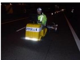
みつけるくんK (舗装の上から鋼床版き裂位置を特定できる鋼床版検査装置)
